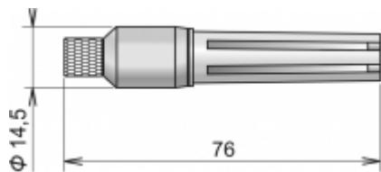
Digital givare med kontaktdon typ ELKA, direct insertion.
