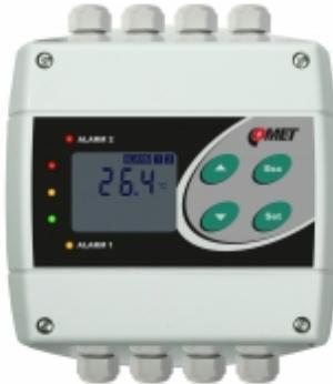
Temperaturtransmitter och regulator för extern Pt1000-givare med två reläutgångar för mätning, övervakning och reglering av omgivningstemperatur inomhus eller utomhus. RS232 för seriell kommunikation.
