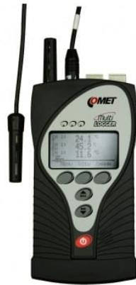
Universal datalogger med 2 ingångar för anslutning av temperatur och luftfuktighetsgivare eller Pt1000 samt 2 ingångar för analoga eller digitala signaler samt intern CO2-givare. Multilogger kan installeras permanent ansluten till nätverk (Ethernet) eller användas som ett portabelt instrument. Levereras med spårbart kalibreringscertifikat i enlighet med EN ISO/IEC17025.
