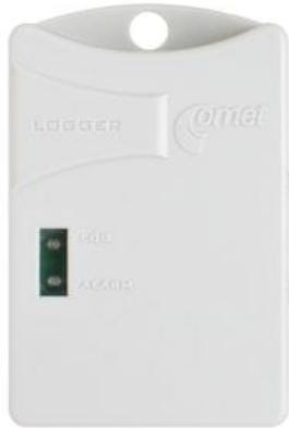
Temperaturlogger för loggning av omgivningstemperatur. Värdena lagras i ett icke-flyktigt minne och kan överföras till PC med adapter för USB, RS232 eller Ethernet. Ekonomiversion med något högre toleranser än R0110.
