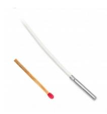
Sonderna är designade för kontaktmätning av temperaturen på gasformiga, flytande eller fasta ämnen. Ultra tunn 3 mm diameter på höljet säkerställer snabb respons på temperaturförändringar. Den använda typen av ledarledning har teflonisolering med skärmning. Sensorerna är designade för universellt bruk.
