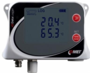
Datalogger avsedd för loggning av temperatur från upp till fyra externa Pt1000-givare (ingår ej, se Tillbehör nedan). I händelse av larm så kan enheten skicka SMS eller JSON-meddelanden via mobilnätet. Den kan även skicka JSON-meddelanden till COMET Database eller molntjänst, mät- och sändningsintervall är justerbara.
