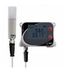
Batteridriven datalogger med intern atmosfärtryckssensor och för extern CO2-sond upp till 10 000 ppm. Vid överskridna gränsvärden indikeras larm lokalt med LED, LCD och akustiskt med inbyggd summer.
